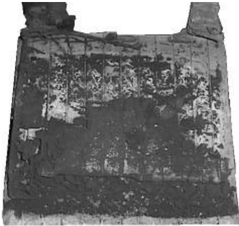
Voorbeeld van corrosie door overlading; zowel c.q. het rooster als PAM vormen één massa.
